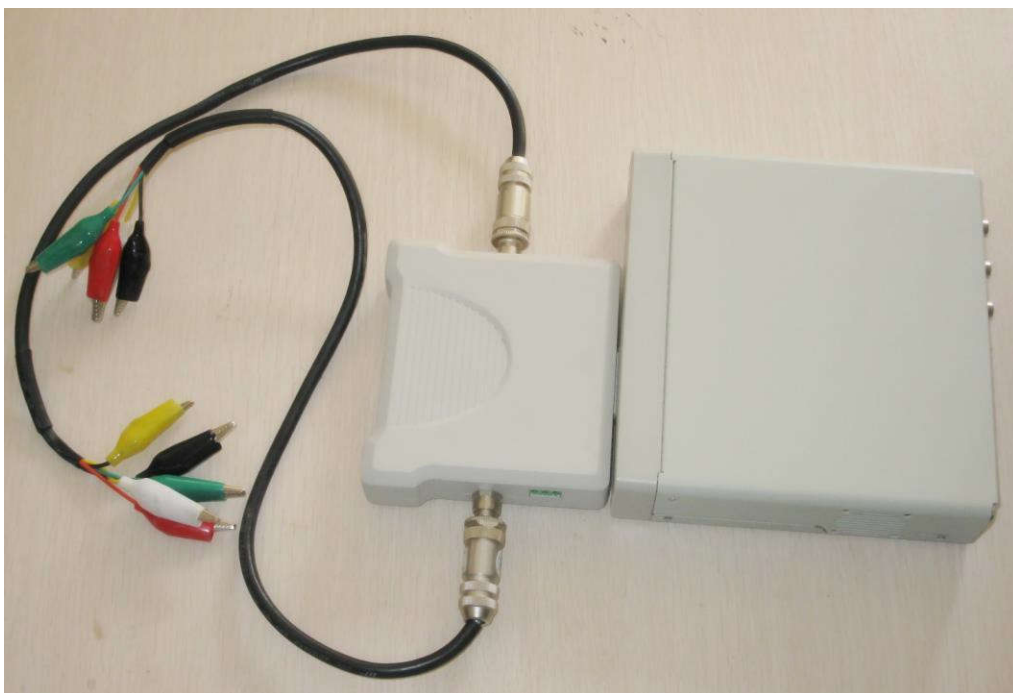
图 2.9 加上扩展板后的测量组合
